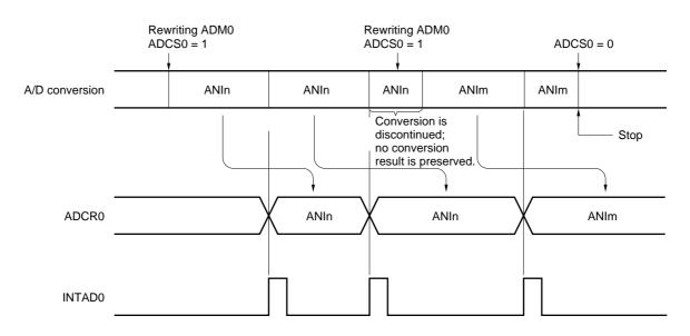
Figure 12-6. Software-Started A/D Conversion
